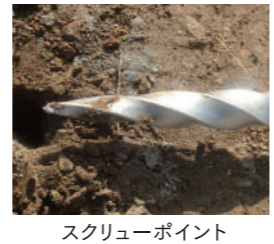
スクリーウエイト貫入試験 (スウェーデン式サウンディング試験)
